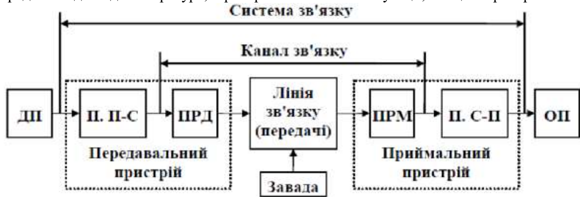
Рисунок 1 – Узагальнена схема системи зв'язку з завадами
