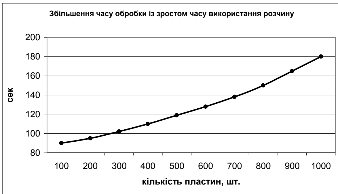
Рис. 6. Збільшення часу травлення пластин із зростом часу використання розчину
