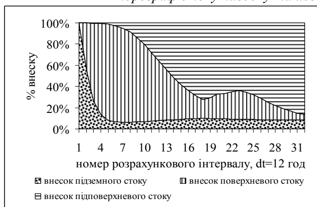
Зміни внесків різних видів стоку з часом при формуванні стоку в замикальному створі
