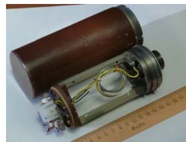
Рис. 2. Загальний вигляд блоку детектування на основі CdZnTe у конструктиві БДМГ-41
