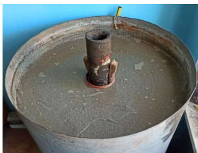
Рис. 2. Модель пласта піскови́ка ( \delta = 1,8 \text{ г/см}^3 ) з бурильною трубою 120 x 25 для калібрування приладів LWD-ГГК
