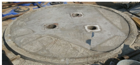
Рис. 3. Універсальна модель карбонатного пласта \delta_{\text{с.п.}} = 2,20 \text{ г/см}^3 , \delta_{\text{в.п.}} = 2,41 \text{ г/см}^3 , k_n = 21,0 \% із трьома свердловинами (200 мм, 160 мм, 125 мм) для калібрування приладів WL-PK і LWD-PK
