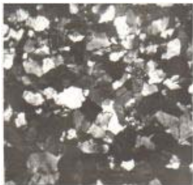
Рис. 3. Пісковик кварцовий, середньо-дрібнозернистий, алевритистий. Регенераційно-інкорпораційні структури на контактах зерен кварцу. Свердловина 75-Завода. Інтервал 4520–4524 м. Нік. +; \times 70
