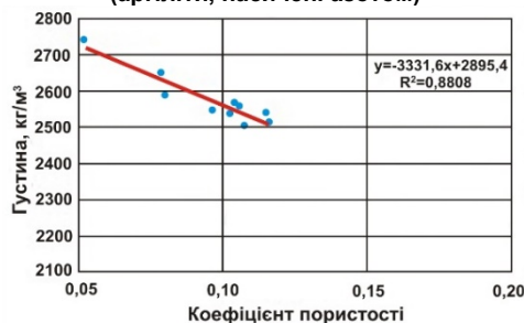
Рис. 3. Залежність густини порід від коефіцієнта пористості (аргіліти, насичені розчином NaCl)
