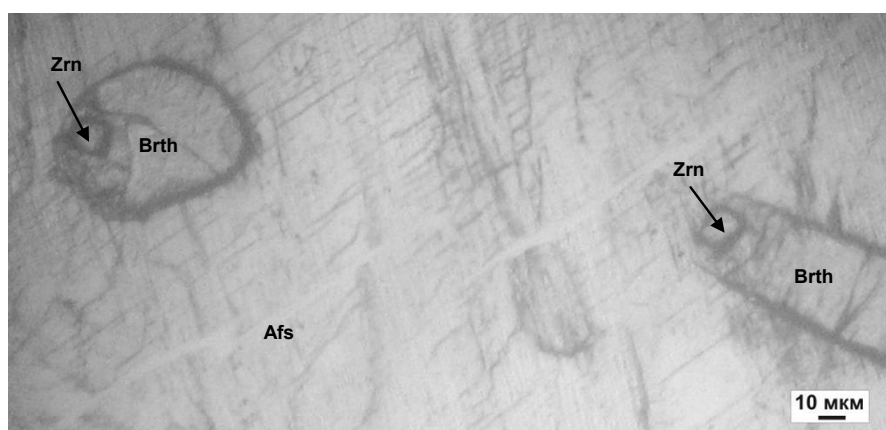
Рис. 2. Кристали бритоліту в анортотлаз-мікропертиті з пропорційними включеннями циркону. Мікрофотографія шліфа; ніколи II. Умовні позначення: Brth – бритоліт, Zrn – циркон, Afs – анортотлаз-мікропертит
