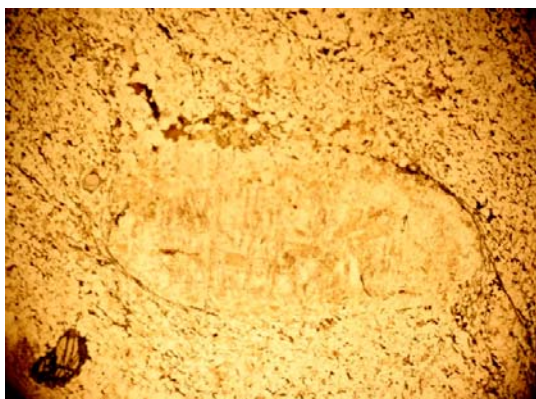
Рис. 4. Неподрібнений реліктовий кристалокласт (у минулому – кристалобласт ранніх лейкократових, пегматоїдних тектонітів), зруйнований по периферії в процесі транспортування серед дрібнозернистої маси тектонітів. Мікрофотографія шліфа; ніколі +
