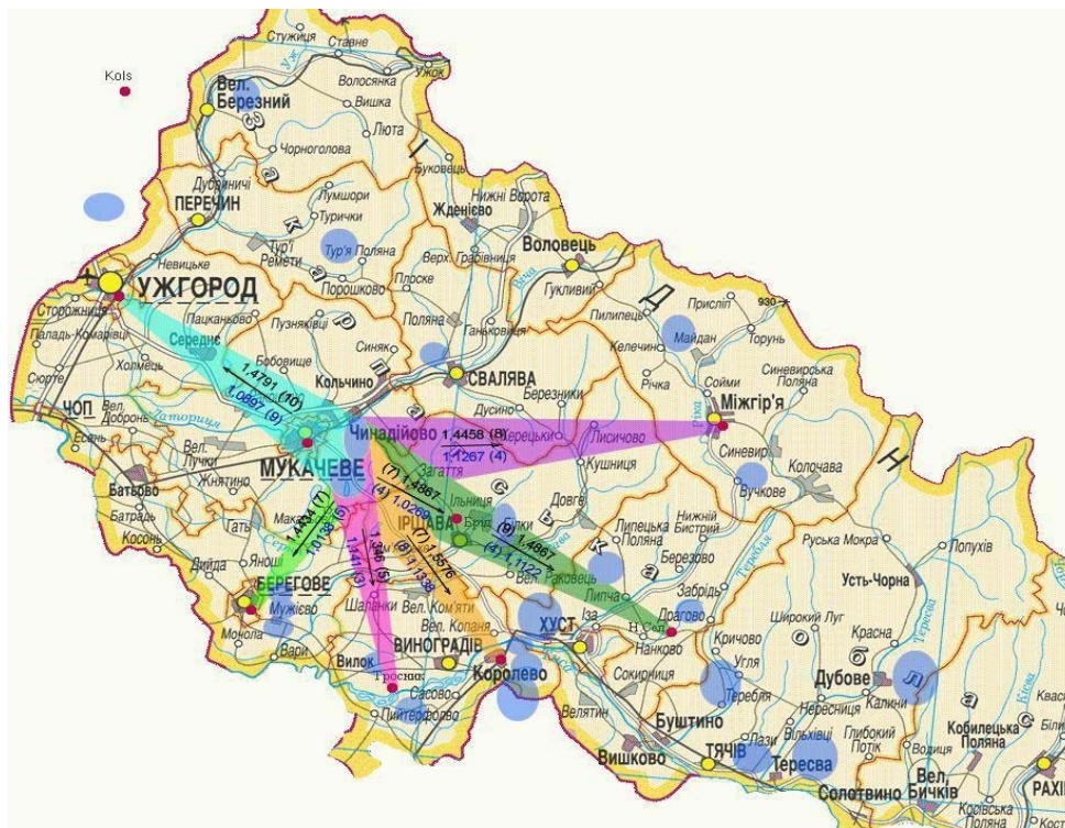
Рис. 5. Спосіб виділення секторів: за основу взято область сейсмічних подій і виділено сектори до сейсмостанцій
