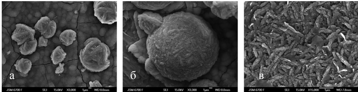
Рис. 5. Глобули кремнезему та деталізація їх поверхні. Електронний мікроскоп JSM-6700 F
