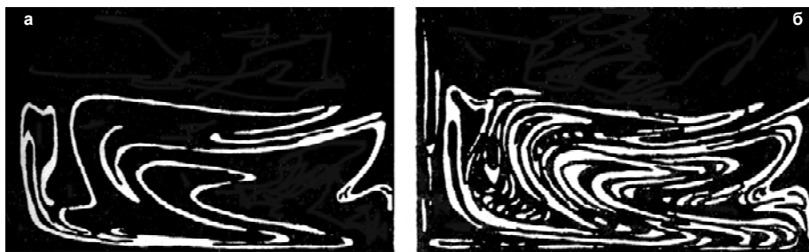
Рис. 1. Структури зсувної течії – складки ламінарної течії, що отримані при знакозмінному зсуванні рідини (гліцерин з алюмінієвим порошком) поздовж горизонтальної поверхні у прямокутній камері:
