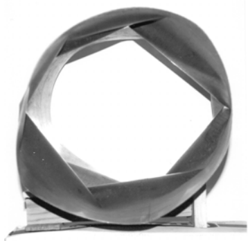
Рис. 4. Форма втрати стійкості оболонки після зняття навантаження
