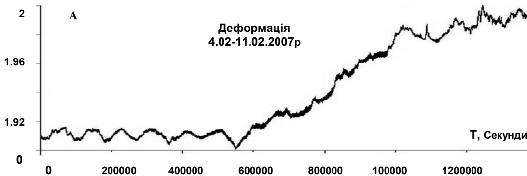
Рис. 1. Запис ходу деформації з 4.02. по 11.02.2007 на РГС "Берегово", зареєстрованого деформографічним лазерним вимірювальним комплексом
