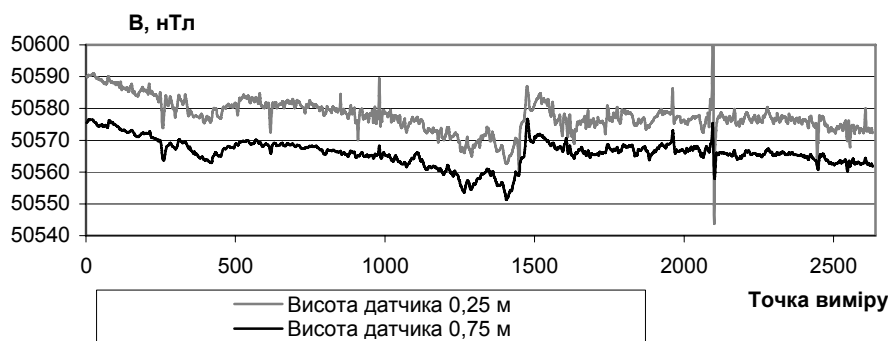
Рис. 3. Графіки магнітного поля В дослідної ділянки "Горобії"
