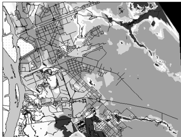
Рис. 3. Карта глибин залягання підземних вод на території лівобережної частини м. Київ. Ліворуч р. Дніпро. Ділянки білого кольору в лівій частині карти – правий берег, острови, Русанівка, де розрахунок не проводився. Відтінки сірого кольору на лівому березі – різні глибини залягання підземних вод
