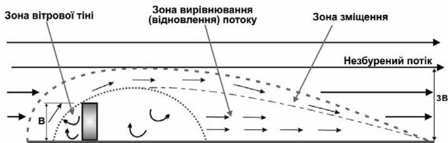
Рис. 3. Схематичне зображення структури повітряного потоку, що нашоується на будівлю, яка розташована на значній відстані від інших [9]
