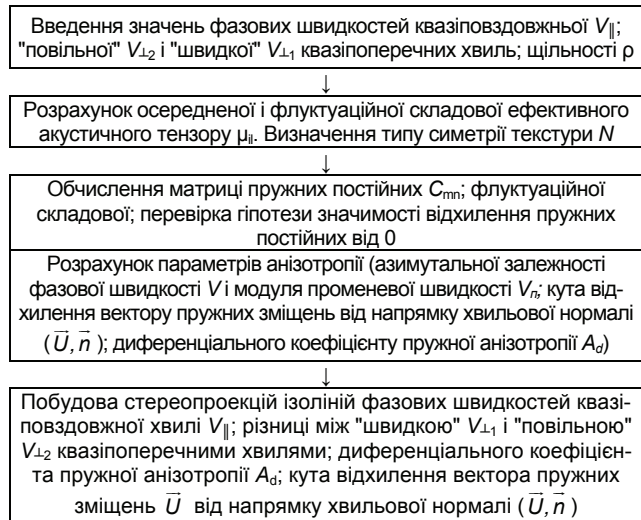
Рис. 1. Принципова схема алгоритму роботи автоматизованої системи чисельного аналізу і візуалізації даних ультразвукових вимірювань параметрів анізотропії швидкостей пружних хвиль
