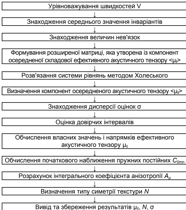
Рис. 2. Принципова схема алгоритму розрахунку осередненої і флуктуаційної складової ефективного акустичного тензору \mu_{ij} та типу симетрії текстури N
