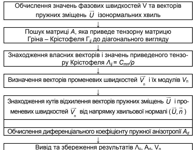
Рис. 4. Принципова схема алгоритму розрахунку параметрів анізотропії гірської породи (азимутальної залежності фазової швидкості \bar{V} і модуля променевої швидкості V_n ; кута відхилення вектору пружних зміщень \bar{U} від напрямку хвильової нормалі (\bar{U}, \bar{n}) ; диференціального коефіцієнту пружної анізотропії A_d )
