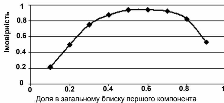
Рис. 3. Залежність імовірності підтвердження подвійності зорі від долі в загальному блиску першого компонента. Розрахунки для зорі спектрального класу G0, 9 m , проекція відстані між компонентами \rho = 0.01'' , \alpha = 30^\circ , фільтр R.
