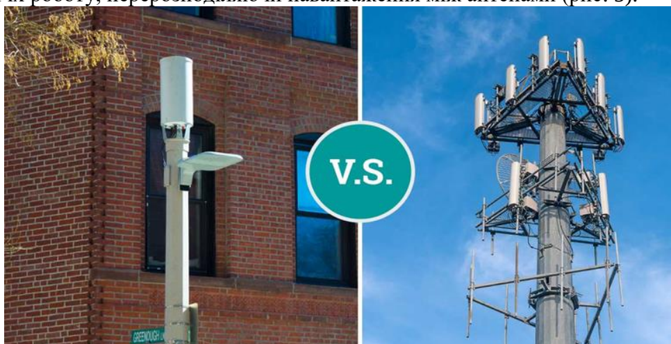
Рисунок 5 – Рішення small cells (зліва), в порівнянні зі звичайною базовою станцією Macro BTS в мережі попередніх поколінь
