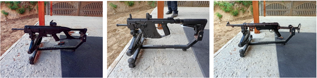
Рис. 4. Спосіб фіксації зброї калібру 9х21 мм перед проведенням експериментальної стрільби (ліворуч – «Taurus CT9», праворуч – «М.Р.38», по центру – «Kriss Vector SBR Gen II»).
