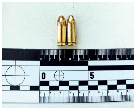
Рис. 2. Зображення пістолетного патрону калібру 9x19 mm Parabellum (ліворуч) та пістолетного патрону калібру 9 × 21 mm IMI (праворуч).
