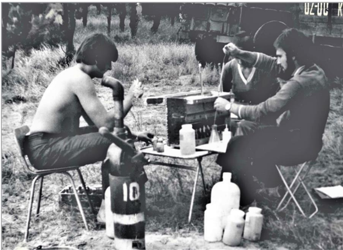
Ф.7. Химический анализ проб воды на берегу озера Свитязь с помощью полевой лаборатории анализа воды (ПЛАВ). Экспедиция Киевского государственного университета им. Т.Г. Шевченко. Шацкие озера, Волынь. 1975 г.
