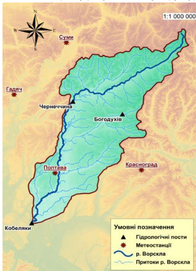
Рис. 1. Схема розташування пунктів спостереження, за даними яких обчислено водний баланс річок басейну Ворскли
